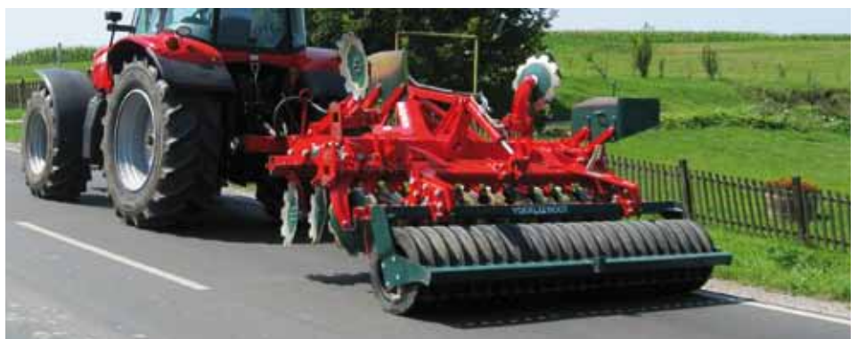
A TerraDisc pro TR elérhető 3,00, 3,50* valamint 4,00* méteres merev vázas kialakításban
