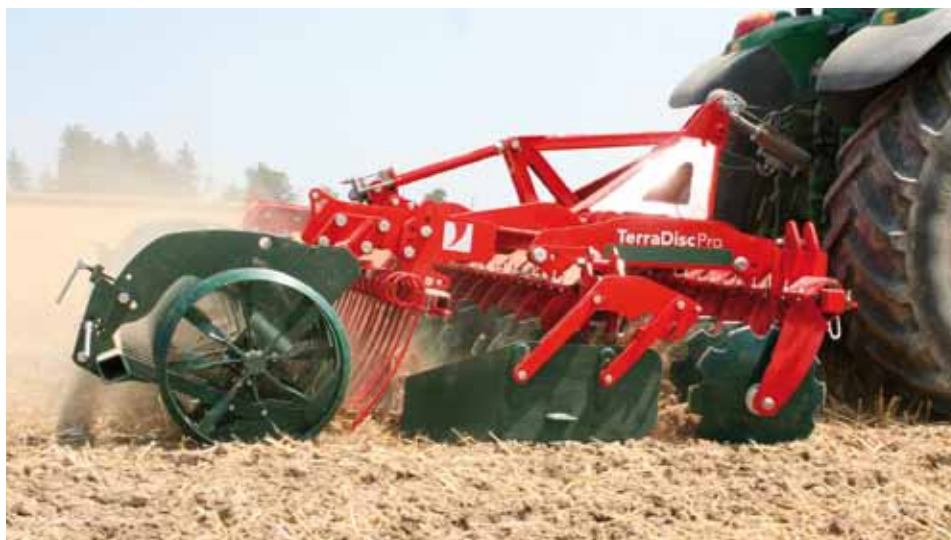
A merev vázú TerraDisc pro elérhető 3, 3,5* és 4* méter munkaszélességekben * Szállítási szélesség több, mint 3,00 m
